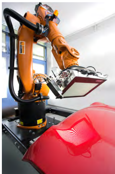
Abb. 1: Sensorik für die Deflektometrie: Robotergeführter Sensorkopf (links), Deflektometrie-CAVE (rechts).
