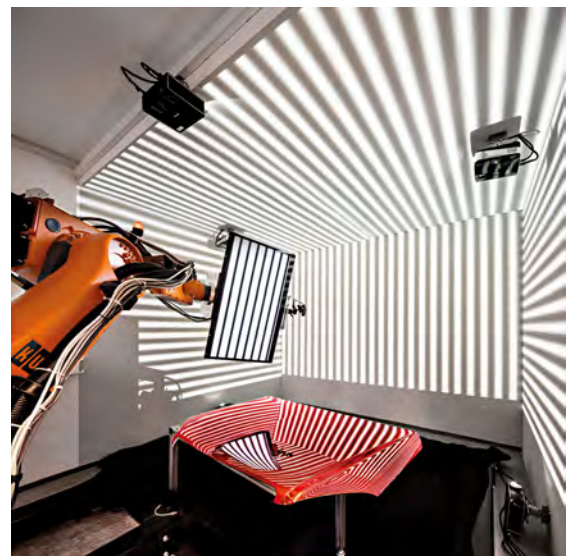
Abb. 1: Sensorik für die Deflektometrie: Robotergeführter Sensorkopf (links), Deflektometrie-CAVE (rechts).
