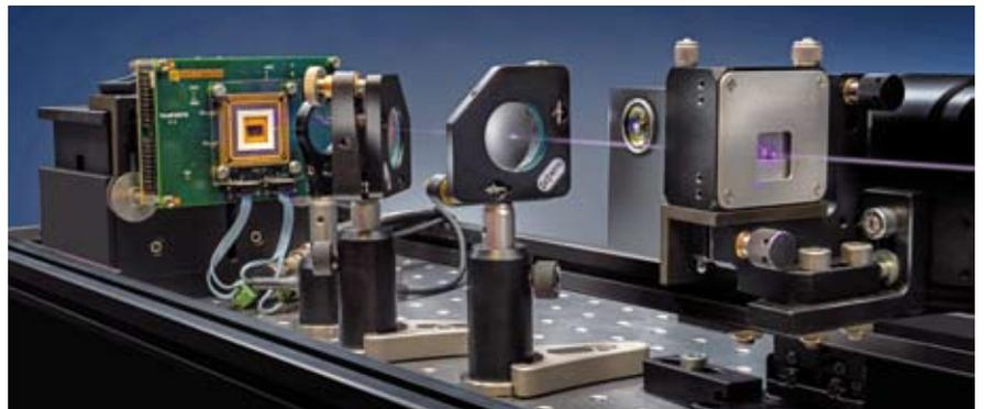
*QGI-Aufbau am IOSB. Ein spezieller Kristall (r.) erzeugt aus Laserlicht verschränkte Photonenpaare; der sichtbare Anteil wird mit einem Silizium-Chip (l.) räumlich aufgelöst detektiert.*
