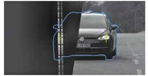
Herkömmliches Bild (rechts) und Aufnahme des VLC-Signals mittels Spezialoptik und Rolling-Shutter-Effekt (links). © Fraunhofer IOSB
