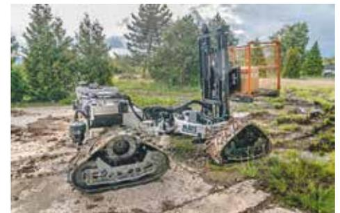
MATS, das mobile autonome Transportsystem, ist eine Demonstrations- und Testplattform für Autonomiefunktionen in unstrukturiertem Gelände. Foto: © Fraunhofer IOSB/indigo
