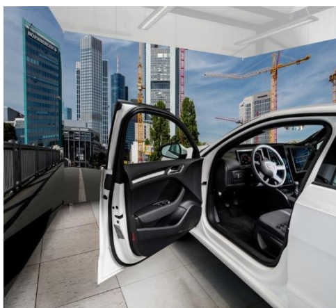
Abb. 2 Zur Durchführung von Studien und Datensammlungen bietet das Fraunhofer IOSB einen Fahr Simulator mit umfangreicher Sensorik im Fahrzeuginnenraum.
