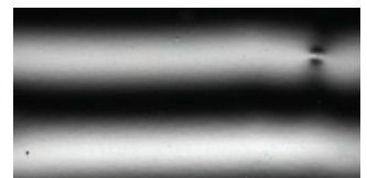
Von Blechprobe reflektiertes Streifenmuster in waagerechter Richtung.
