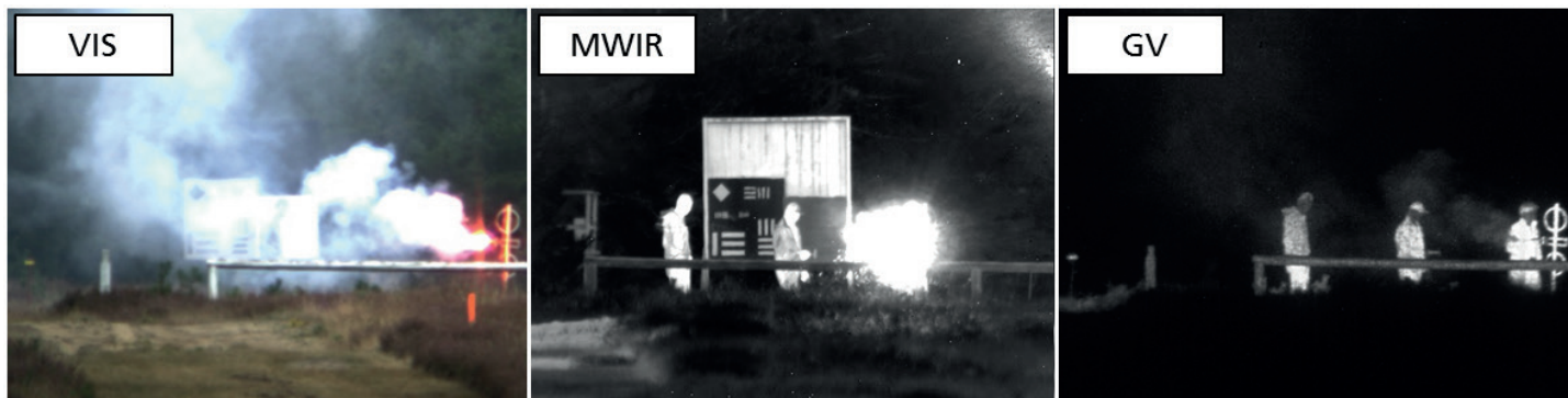
Abb. 2: Zeitgleiche Aufnahmen einer Szene mit Rauch und Feuer durch eine abbrennende Rauchfackel. Links: gewöhnliche Aufnahme im visuellen Spektralbereich. Mitte: MWIR-Bild. Rechts: Gated-Viewing-Bild, welches deutlich eine dritte Person in der Szene zeigt.
