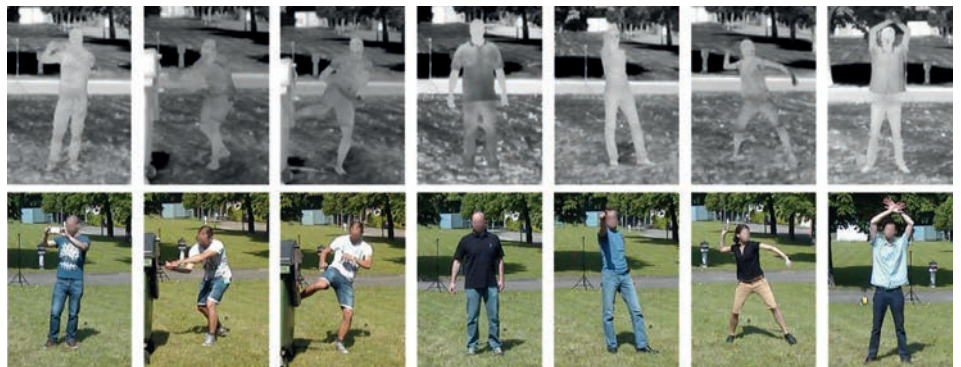
Abbildung 1: sieben Aktionsklassen (von links nach rechts: Filmen, Schlagen, neutral, Zeigen, Werfen, Winken). Die Videosequenzen wurden parallel im sichtbaren Spektrum sowie im langwelligem Infrarot -Spektrum aufgenommen.
