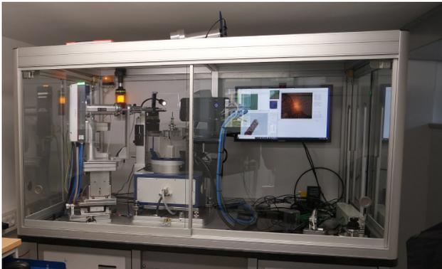
*Anlage zur Untersuchung von Kristallen mittels Röntgenbeugung.*
