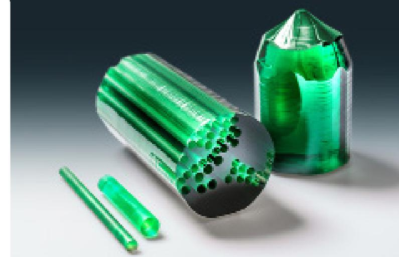
*Beispiel für einen Kristallrohling, einen gebohrten Kristallrohling und ausgebohrte Stäbe des Laserkristalls.*
