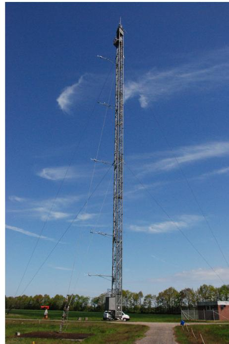
Meteorologieturm (bis 64m Höhe) mit Ultraschall-Anemometer
