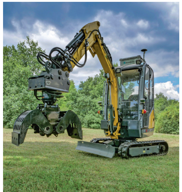
Die Alubox auf dem Dach ersetzt den Menschen in der Kabine: der autonome Bagger IOSB.BoB auf dem Weg zum Einsatzort.
