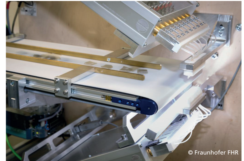
Einsatz des THz-Sensors in einem Sortiersystem. Unten der THz-Sender, oben der THz-Empfänger. Die rechts anschließende Trenneinheit mit den Druckluftdüsen wurde für das Foto entfernt.
