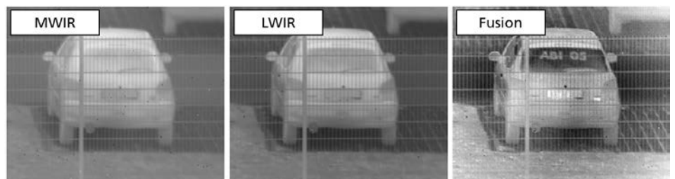
Abb. 1: Aufnahmen eines parkenden Fahrzeugs mit einer IR-Dual-Band-Kamera (Links: MWIR, Mitte: LWIR). Rechts: Bildfusion der beiden Bänder, wodurch ein Schriftzug auf der Heckscheibe herausgestellt wird.
