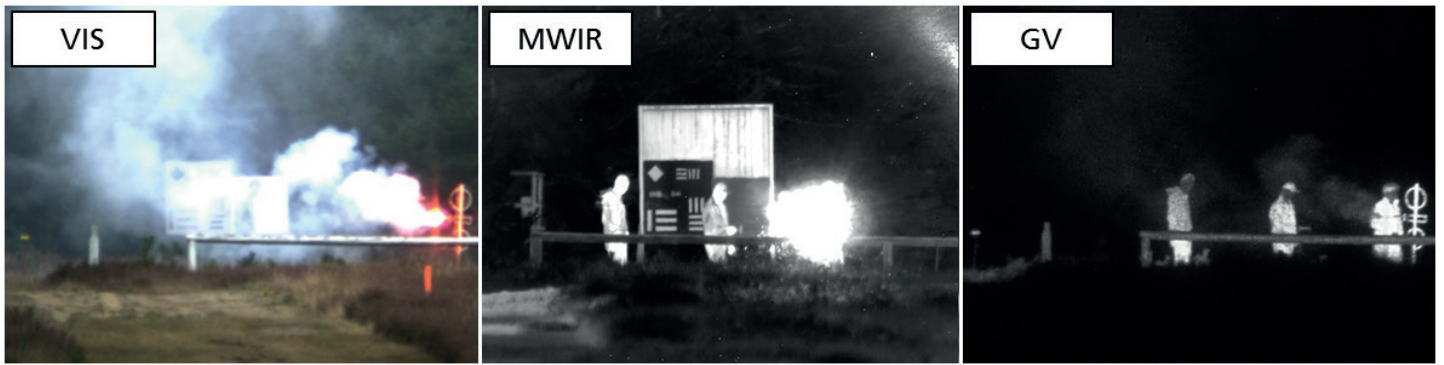
Abb. 2: Zeitgleiche Aufnahmen einer Szene mit Rauch und Feuer durch eine abbrennende Rauchfackel. Links: gewöhnliche Aufnahme im visuellen Spektralbereich. Mitte: MWIR-Bild. Rechts: Gated-Viewing-Bild, welches deutlich eine dritte Person in der Szene zeigt.
