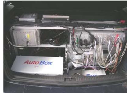
Abbildung 3: Signalverarbeitung und Rechner im Versuchsfahrzeug
