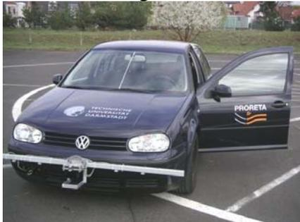
Abbildung 2: Versuchsfahrzeug mit Sensorik für das Fahrzeugumfeld
