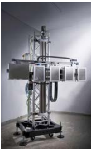
Kontaminationsarray zur Freimessung in Gebäuden. (Foto: KIT/Amadeus Bramsiepe)
